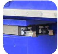
+ Servo-entraînements AC avec crémaillères à engrenages hélicoïdaux (des deux côtés)
