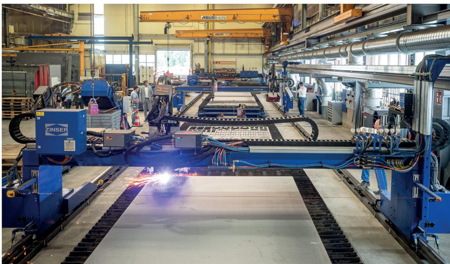
Die beiden neuen ZINSER 4025, jeweils mit einem Plasmafasenaggregat, einem Plasmabrenner gerade und zwei Autogenbrennern auf einer 41 m Laufbahn.
