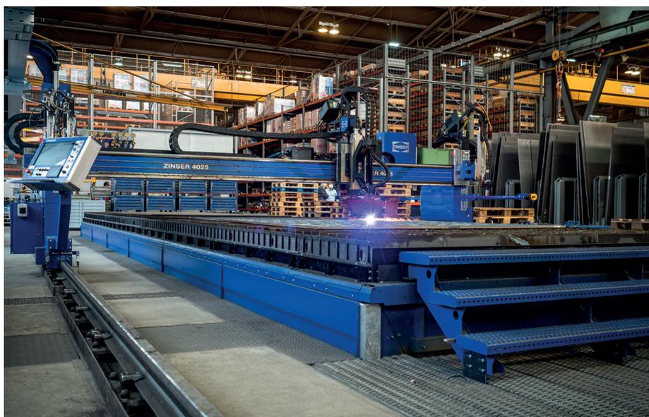
Das innovative 5-Achs-System erlaubt Plasmafasenschnitte bis zu 50° Winkel, sowie höhere Genauigkeiten und Schnittqualitäten als je zuvor.
