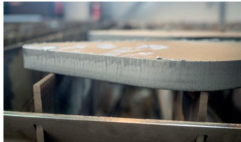
„Durch die 50°-Fasentechnologie haben wir eine enorme Kosten- und Durchlaufzeitenreduktion“, erklärt Lamparter. Ein weiteres wichtiges Kriterium für die Entscheidung zugunsten von ZINSER war die einfache Programmierbarkeit der ZINSER Schneidsoftware. Gesteuert werden beide Maschinen von der modernen CNC-Bahnsteuerung ZINSER 5010 mit Windows 10 / 64 Bit, auf komfortablen 22“ TFT
