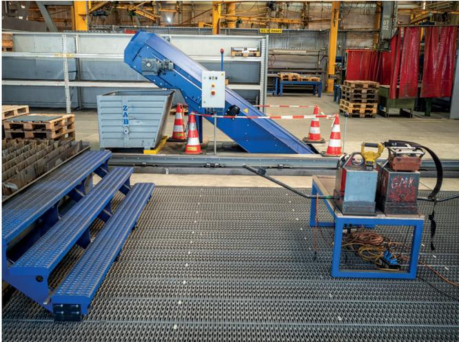
Ein modernes ZINSER System zum Rückstandsabtransport bestehend aus zwei ZINtrac Schwingfördertischen, verbunden durch einen Schlackeförderer mit Auswurf, komplettiert das Gesamtkonzept zur State-of-the-art-Lösung für die Brennschneidaufgaben der Liebherr-Werk Biberach GmbH.
