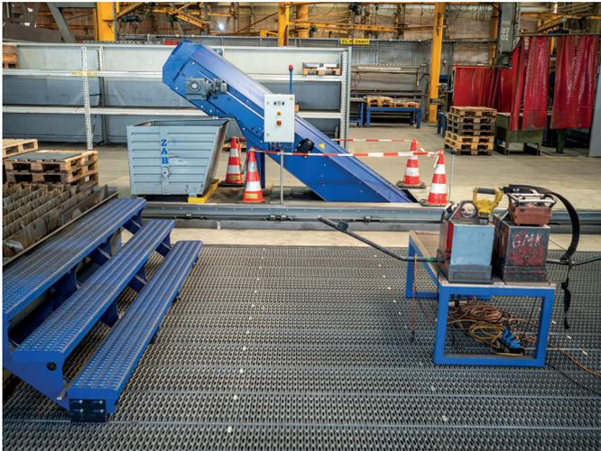
Un système ZINSER moderne pour l'élimination automatisée des déchets, composé de deux tables de convoyage oscillantes ZINTRAC combinées à une solution d'éjection et de collecte des déchets, fait de l'ensemble de l'installation une solution de pointe pour la découpe chez Liebherr-Werk Biberach GmbH.
