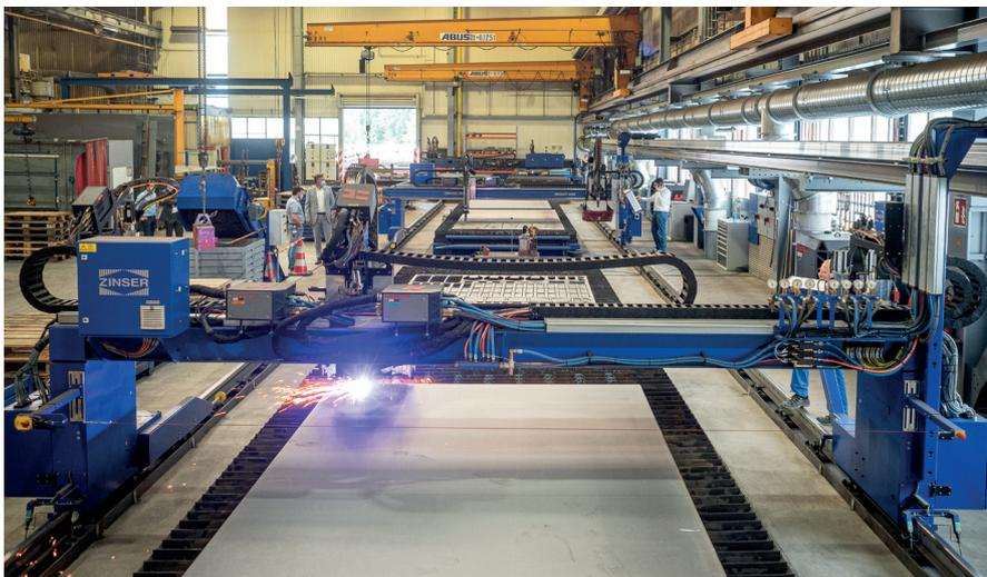
Les deux nouvelles ZINSER 4025, chacune équipée d'une unité de chanfrein plasma, d'une torche plasma droite et de deux chalumeaux d'oxycoupage, roulent sur une piste commune de 41 m de long.
