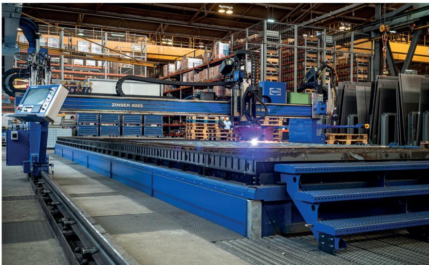
Le système innovant à 5 axes permet des coupes de chanfreins plasma jusqu'à 50°, ainsi qu'une précision et une qualité de coupe plus élevées que jamais.
