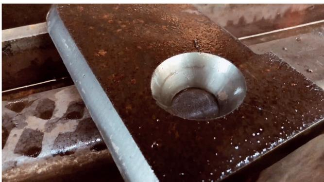
Werkstücke mit unterschiedlichen Fasen, geschnitten mit dem Fasenaggregat auf der ZINSER 4025 von Arpogaus
