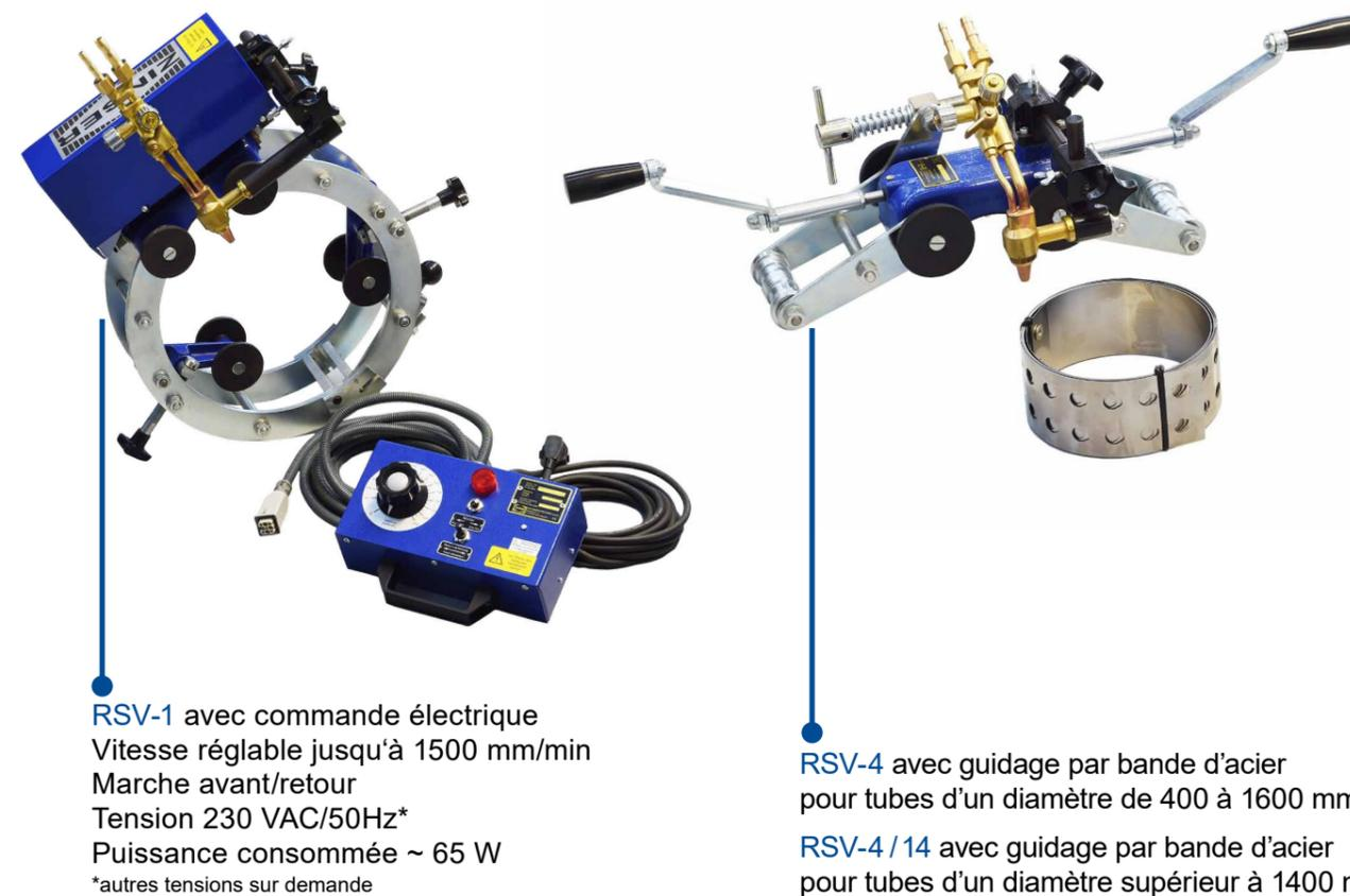
Les chanfreineuses sont conçues de telle sorte qu'elles peuvent être montées à tout endroit sur un tube sans fin. La fixation de la RSV se fait par un verrouillage rapide.
