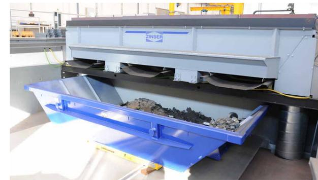
A l'extrémité de la table, le sol doit comporter une fosse pour les bacs de collecte des scories et des petites pièces. Ces bacs peuvent être levés par des grues ou des chariots élévateurs. Pour plus d'automatisation, un système de convoyage peut être installé au bout des goulottes vibrantes afin de transporter les déchets et les pièces jusqu'à un container central.
