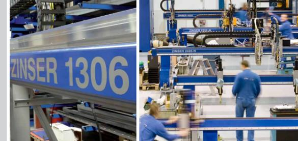
Les machines de coupe ZINSER 1304 et 1306 ont été spécialement conçues pour le travail sur tubes. (ZINSER 1304 pour tubes cylindriques, ZINSER 1306 pour tubes cylindriques et prismatiques.) Les perçages, les découpes, les coupes circulaires ainsi que l'usinage de bouts de tubes se réalisent d'une façon rapide et rationnelle. De nombreuses figures standard
