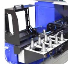
**+** Automatischer Werkzeugwechsler für bis zu 8 Werkzeuge
