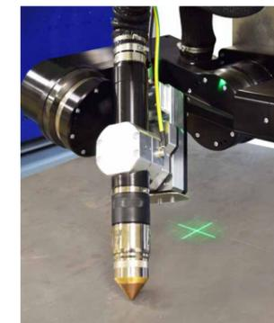
Laserdiode zum Einrichten des Programmstartpunkts, optional mit Kamerasystem
