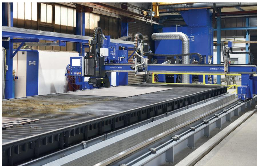
Das Materialspektrum von Hilgefert umfasst C-Stahl, Edelstahl, Aluminium und Kupfer, die mit der neuen ZINSER problemlos bearbeitet werden können. Besonders die Bearbeitung von 3-D Konturen im Radius ist ein weiteres Highlight der Anlage.
