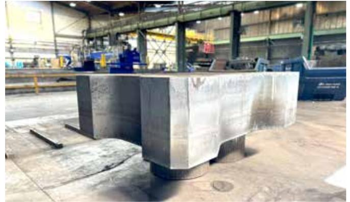
Fertig geschnittenes Teil, das später in einer hydraulischen Presse verwendet wird.
