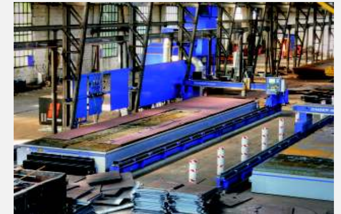
Heute: Automatisches Freiräumen des Schneidisches
