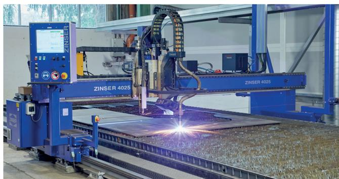
Eine der beiden neuen ZINSER 4025. Diese ist ausgestattet mit einem Autogenbrenner und dem hochdynamischen ZINSER-Plasmafasenaggregat.
