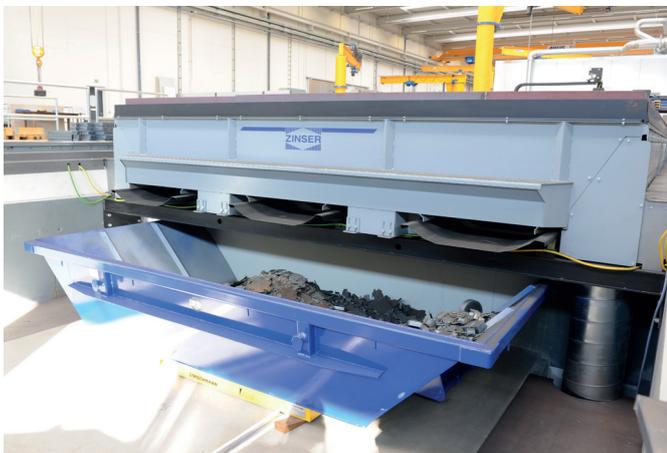
Rückansicht eines in den Boden eingelassenen ZINTRAC Schwingfördertisches. Die während des Schneidbetriebs entstehenden Brennrückstände und Schneid-schlacken werden durch die vibrierenden Förderrinnen aus dem Tischsystem und in bereitgestellte Auffangbehälter transportiert.
